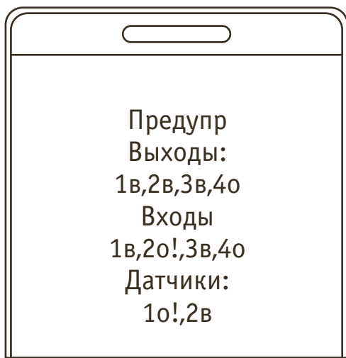
Рис. 2 Пример сообщения о состоянии (предупреждение, ошибка на контрольной точке №2, разомкнут датчик №1)
